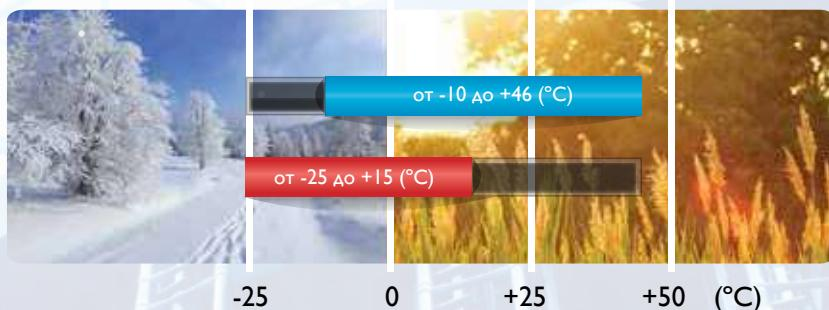
Благодаря новому компрессору SHRM-е может работать в расширенном диапазоне температур наружного воздуха в режиме охлаждения и обогрева – от -25°C до +46°C.
